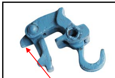
Worn out Anti creep lug
